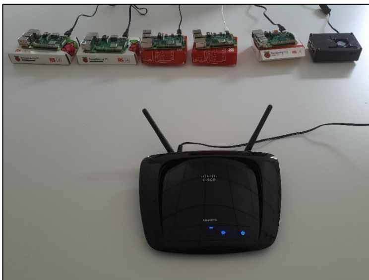
Figure 8 : Six Raspberry Pi connectés au routeur pendant un apprentissage fédéré
